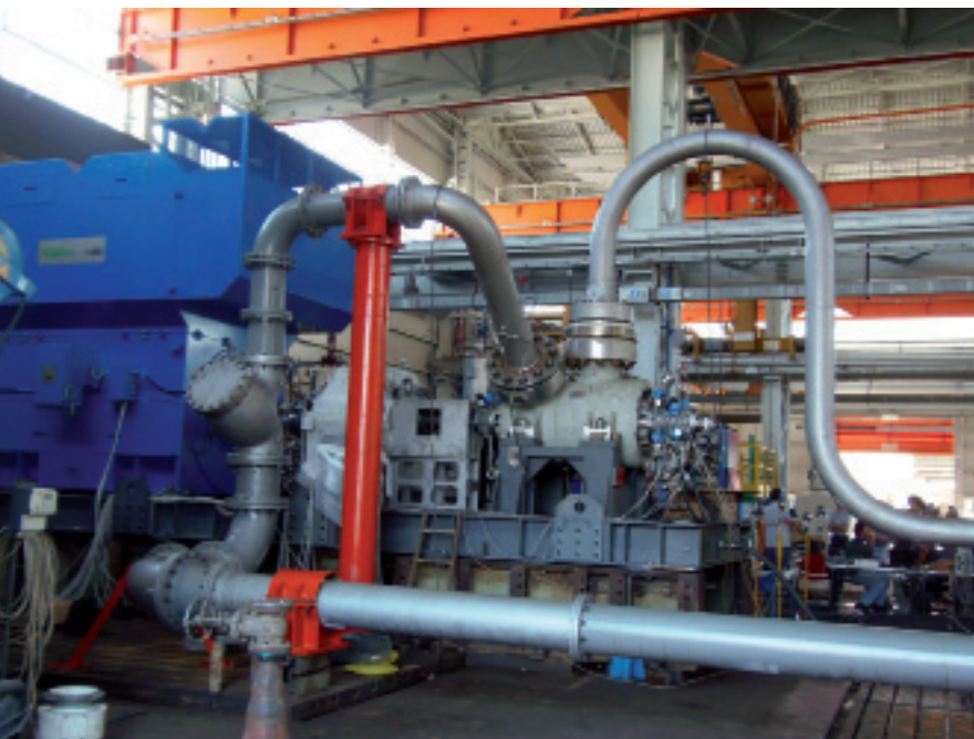
Fig. 2- Main injection pump (MIP) con motore elettrico, moltiplicatore di velocità, tubazioni di aspirazione e mandata
